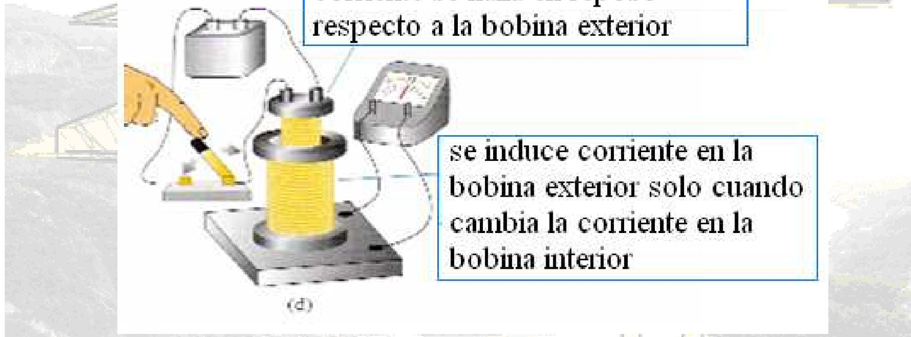
se induce corriente en la bobina exterior solo cuando cambia la corriente en la bobina interior
